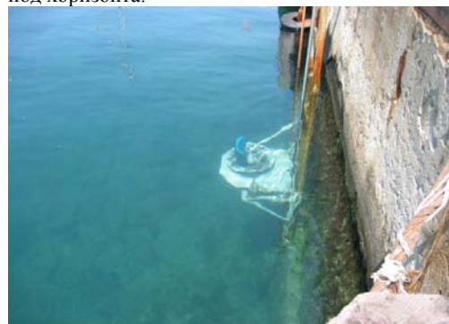
Фиг.7 Херметизираната антена на приспособлението за измерване на диаграмата на насоченост
