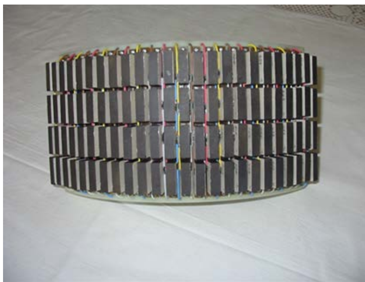
Фиг.3.Многоелементна хидроакустична антена с цилиндрична излъчваща повърхност
