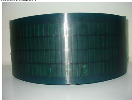
Фиг.6. Херметизирана с полиуретан антена
