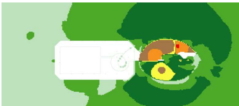
В) Всички вентилационни и климатични сградни/фасадни тела + точкови източници на височина 8.5 м, без предложена бариера на покрива: IND85_ALL_NOBAR_LDEN .
