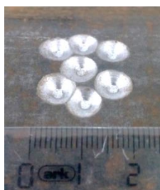
Фиг. 3 Изкуствена локална корозия (Corrosion pit cluster) в тръба (дебелина на стената 4 mm и външен д-р 133 mm)
