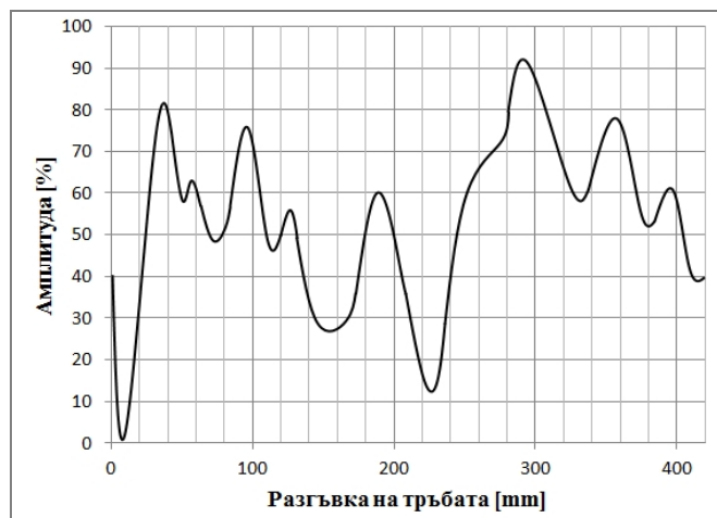
Фиг. 5 Амплитуда на отражението на мода A0 от края на тръба (дебелина на стената 4 mm и външен д-р 133 mm) при периферно сканиране на тръба
