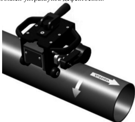
Фиг. 3 Електромагнитен преобразувател, монтиран върху ролков скенер с енкодер
