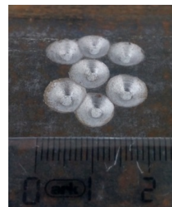
Фиг. 4 Изкуствена локална корозия (Corrosion Pit Cluster) в образец 1
