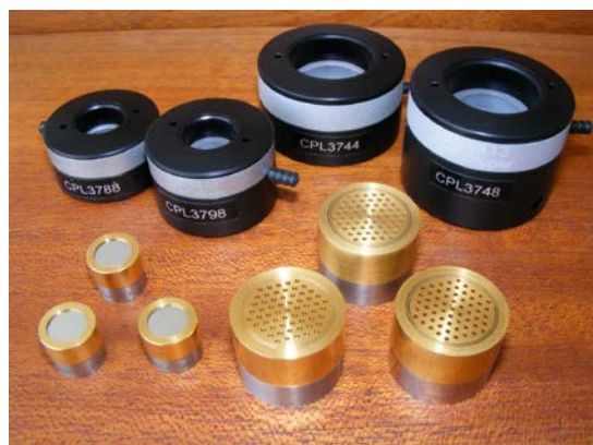
Сн.2 Комплект еталонни микрофони LS1P и LS2P и съответните им малообемни камери
