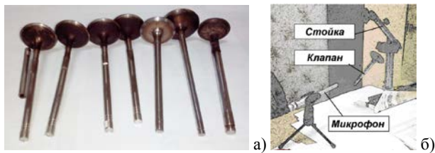
Фиг. 3. Част от клапаните и опитна уредба за изследване на собствените им честоти.
