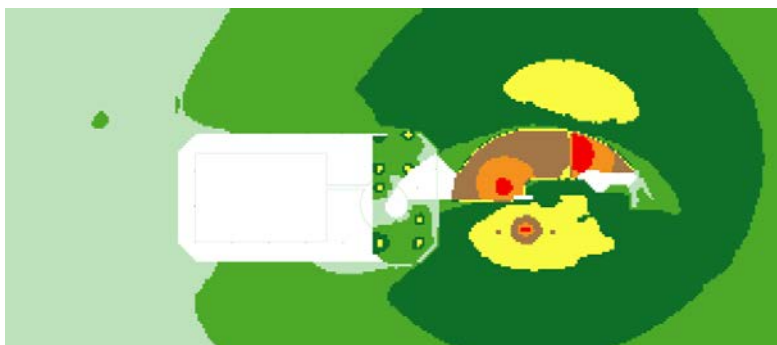
Г) Всички вентилационни и климатични сградни/фасадни тела + точкови източници на височина 11.5 м, без предложена бариера на покрива: IND115_ALL_NOBAR_LDEN .
