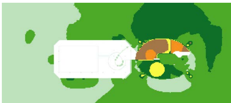
Б) Всички вентилационни и климатични сградни/фасадни тела + точкови източници на височина 5.5 м, без предложена бариера на покрива: IND55_ALL_NOBAR_LDEN.
