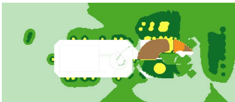
А) Всички вентилационни и климатични сградни/фасадни тела + точкови източници на височина 2м, без предложена бариера на покрива: IND2_ALL_NOBAR_LDEN.
