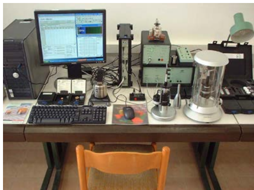
Сн.1 Еталон на единицата за звуково налягане във въздушна среда в ГД НЦМ
