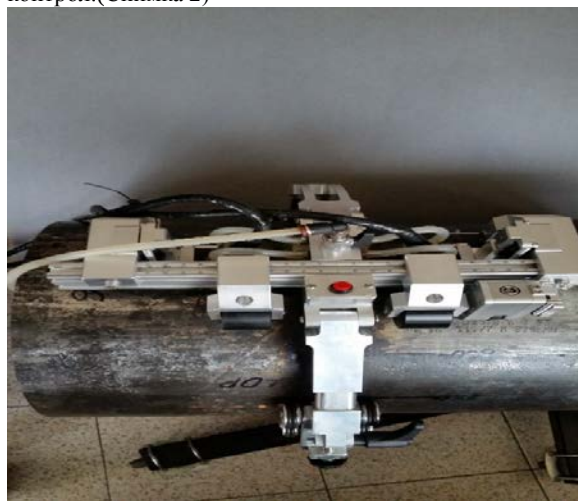
Снимка 2. Автоматизирана система за ултразвуков контрол произведена в Мултитест ООД.
