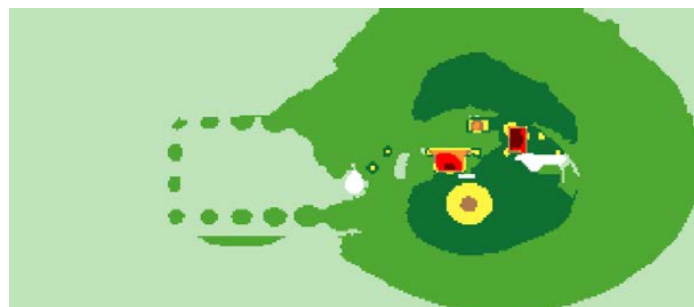
Е) Всички вентилационни и климатични сградни/фасадни тела + точкови източници на височина 14.5 м с предложена бариера на покрива: IND145_ALL_BAR_LDEN
