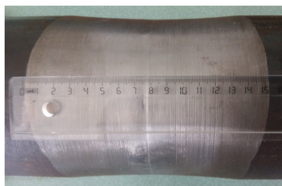
Фиг. 5 Образец с изкуствен дефект, който имитира изтъняване на основата на ел. стълб
